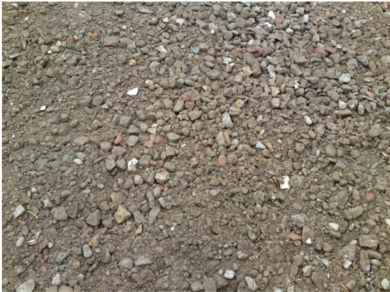
Abb. 24: Frostschuttschicht (gütesichert) aus RC-Material nach dem Einbau in der Straße
