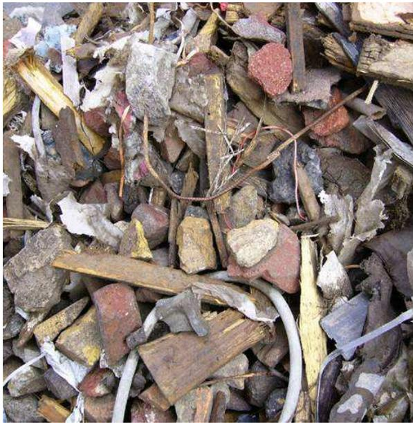
Abb. 54: Zur Aufbereitung und Verwertung ungeeignetes Material
