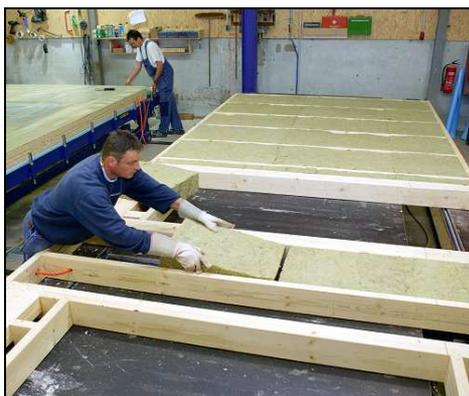
Abb. 22: Vorfertigung in Holztafelbauweise (ScanHaus Marlow GmbH 2012)
