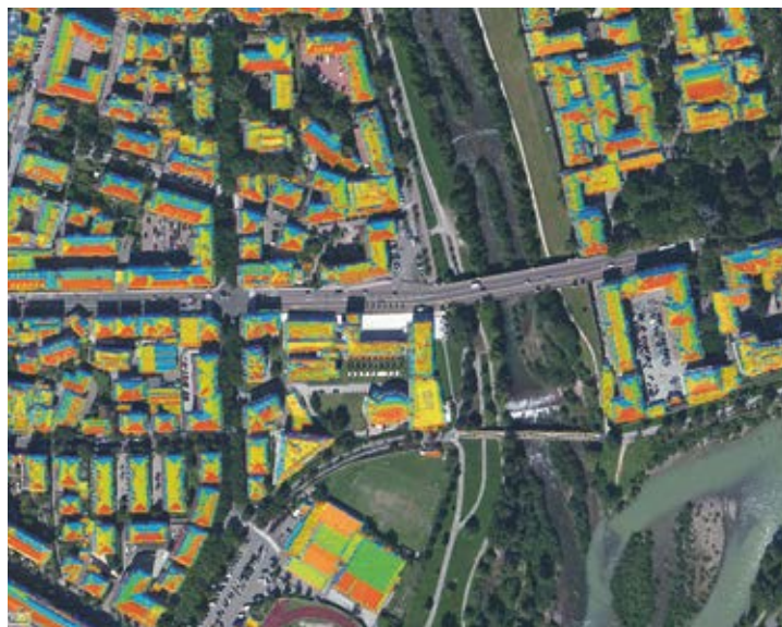
SOLARKATASTER: DIE DACHFLÄCHEN WURDEN OPTISCH ZU ENERGIEKLASSEN ZUSAMMENGEFÜHRT, WOBEI DIE NAVIGATION VON DEN KARTOGRAFISCHEN BASISDATEN UNTERSTÜTZT WIRD.
