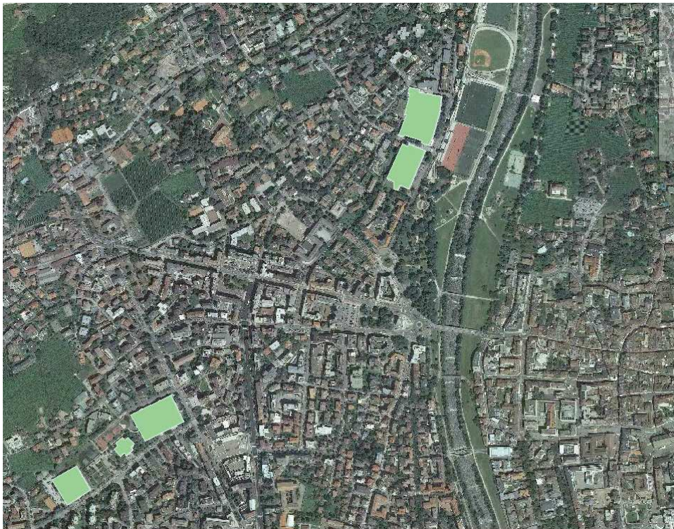
Bild 5: Beispiel für die graphische Darstellung von Gebäuden, welche der Klasse I zuzuordnen wären, die sich aber in einer höheren akustischen Klasse befinden
