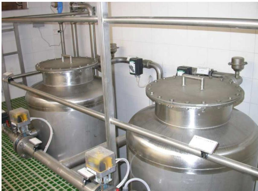
Abbildung 24: Arsenentfernung
