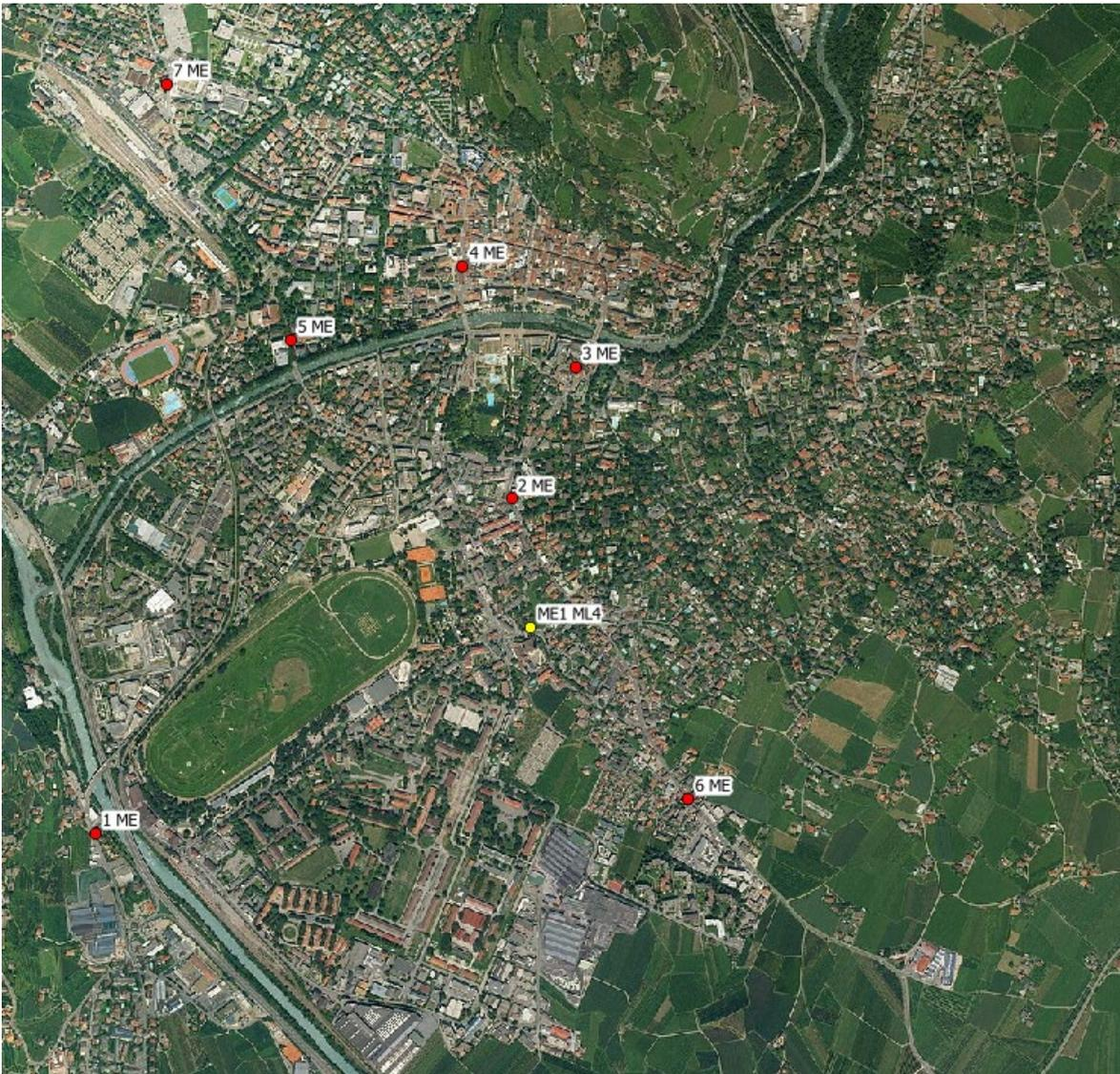
Abb. 5.3: NO<sub>2</sub>-Messpunkte in Meran (ortsfeste Stationen – gelbe Punkte und Passivsammler – rote Punkte)
